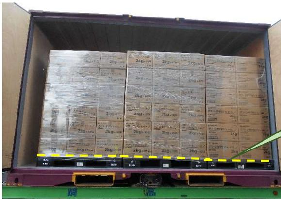
貨物とパレットの間に滑り止めシートを敷くことにより荷崩れ・荷擦れの解消。
