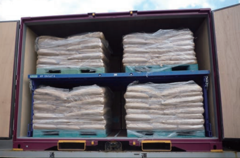
JR5tコンテナ用使用パレットはプラスチックパレット14型です。
